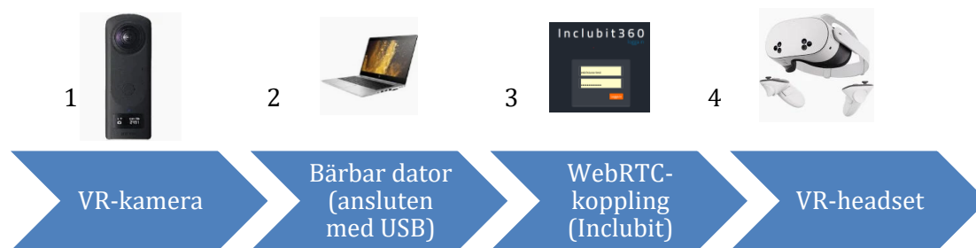
Figur 1. Teknikflöde i VR-baserade VFU-besök. Bilden visar sambandet mellan 360°-kamera, bärbar dator, WebRTC-baserad strömning via Inclubit och valfri mottagarenhet (VR-headset eller skärm).
